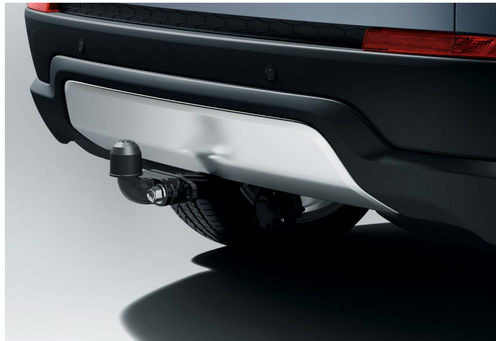
トウイングシステム - フィックスドハイトフランジドトウバー
