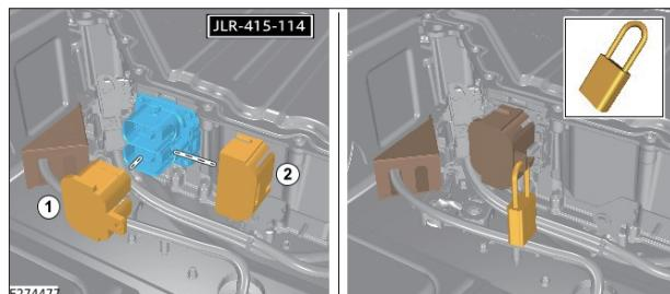
23. 図に示すように、安全チェック コネクタをブレーキ アウト ボックスに取り付ける。
