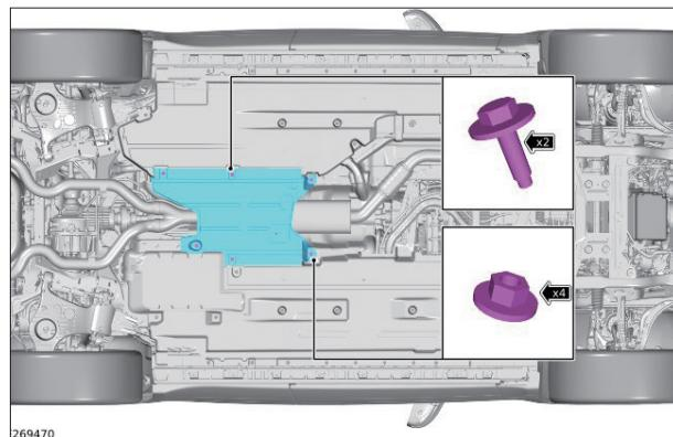
10. ファスナ 9 個、ナット 3 本、およびボルト 3 本を取り外し、左アンダーシールドを取り外す。
