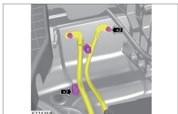
16. 2 本のグラウンド ケーブルを専用工具に取り付ける。
