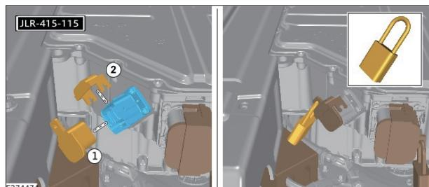
36. 図に示すように、安全チェック コネクタをブレーキ アウト ボックスに取り付ける。
