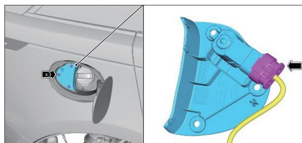
13. プラグイン ハイブリッド電気自動車 (PHEV) バッテリー クーリング システム エクスパンション タンクからフィラ キャップを取り外す。
