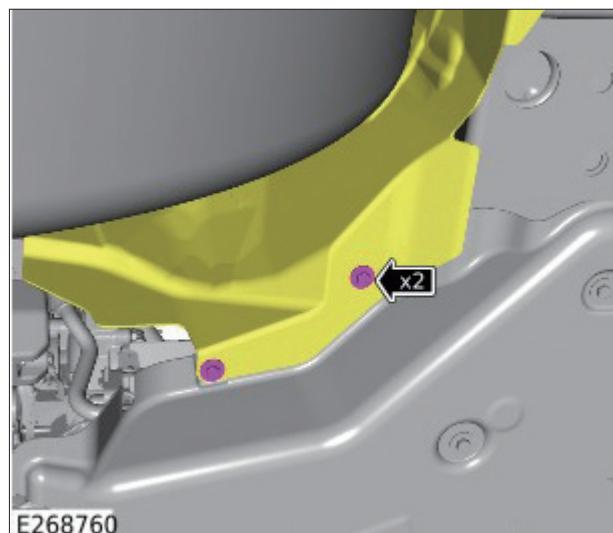
7. ナット 1 個およびボルト 17 本を取り外し、エンジン アンダーシールドを取り外す。
