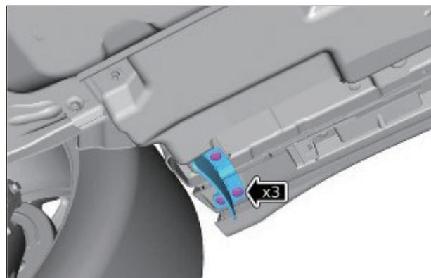
9. ナット 4 本およびボルト 2 本を取り外し、リヤセンタ アンダーシールドを取り外す。
