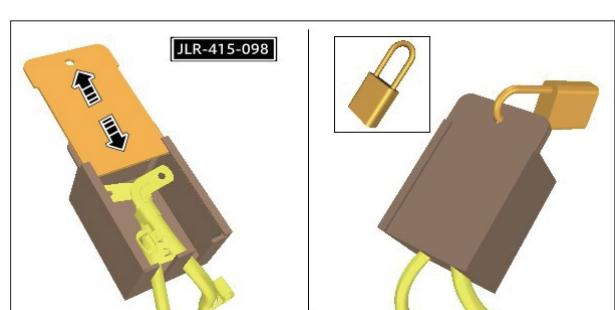
17. 直流 / 直流 (DC/DC) コンバータ コネクタの接続を外す。
