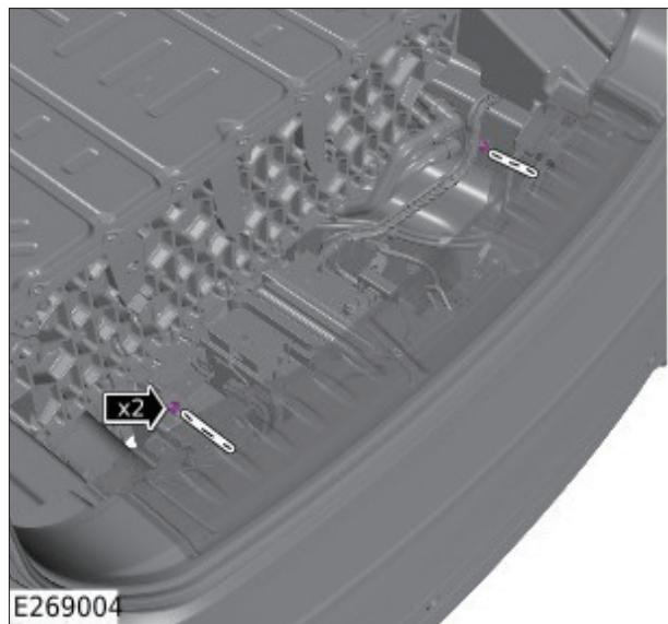
14. 4 個のクリップを外し、テールゲート トレッドプレートを取り外す。
