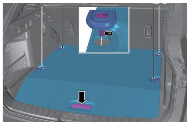
2. パーセル・シェルフを収納し、図に示すように、右クリップ 2 個および左クリップ 2 個を外してパーセル シェルフを取り外す。
