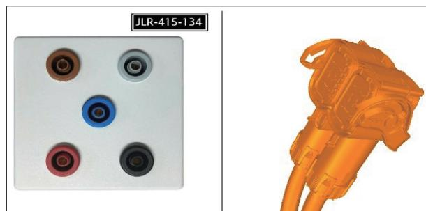
46. 手順 35 ~ 37 で説明されているように、高電圧ブレーカウト ボックスの導通テストを繰り返してから、次に進む。
