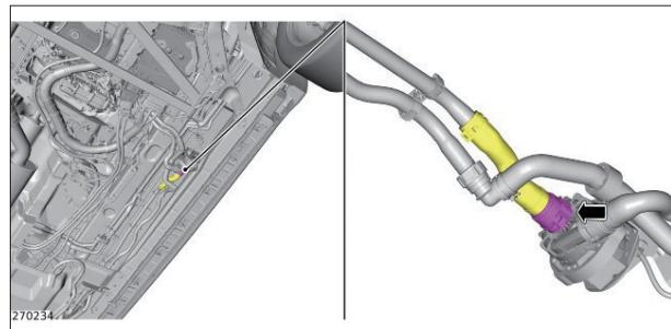
15. インバータ クーラント ポンプ アウトレット ホースの接続を外す。
