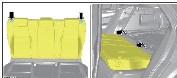
12. 4 本のボルトを取り外し、ラゲッジ コンパートメント フロア トリムを取り外す。
