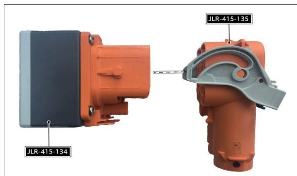
24. 適切な較正済みデジタル マルチメータを使用して、ブレーキアウト ボックスの導通をテストする。HV + および HV - 端子でブレーキ アウト ボックスをテストする。結果は  $440k\Omega$  +/- 5k $\Omega$  でなければならない。
